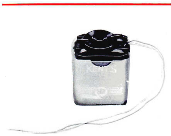
Fig. 6 - Montaggio completo della batteria alimentatrice 9 V. Le due pile piatte risultano inserite in un contenitore di plastica che è contenuto nel kit.
